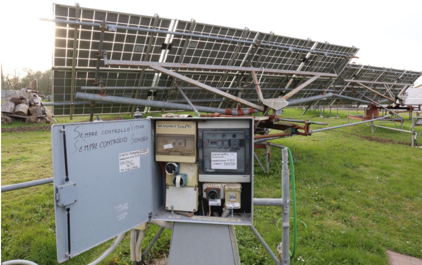
Img. 4. Una delle creazioni più complesse di Elio; si tratta di un sistema meccanico rotativo motorizzato, realizzato per intero con materiali di recupero: tubolari “innocenti” e giunti da ponteggio edile, tubazioni da irrigazione agricola, tamburi del sistema frenante di autocarri, motori elettrici smontati da macchinari ormai in disuso; persino la trivella che ha utilizzato per scavare i fori di ancoraggio dei tubolari sul terreno, sempre a costo zero, è stata composta saldando sul mandrino di un vecchio martello pneumatico una coclea lunga circa un metro, appositamente appuntita intervenendo con la smerigliatrice. Il dispositivo permette ai suoi pannelli fotovoltaici di assecondare il moto terrestre rispetto alla posizione oraria del sole, garantendo una resa complessiva dell’impianto di circa il quaranta per cento superiore all’usuale posizione fissa che, generalmente, prevede un orientamento in direzione sud/sud-ovest, con un’inclinazione tra i venticinque e i trentacinque gradi. Fotografia realizzata da Daniele Parbuono, Paciano, 16 febbraio 2024.
