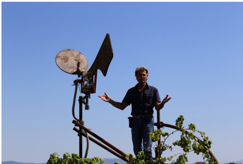
Img. 5. Anemometro, sensore per il vento fai da te. Il dispositivo meccanico di rotazione espone i pannelli fotovoltaici a oscillazioni rischiose in caso di forti raffiche di vento; così Elio ha progettato e costruito questo “marchingegno” in ferro e legno – assicurato su di un’impalcatura realizzata con tubolari innocenti e “tavoloni” da ponteggio, alta circa tre metri – che riesce ad attivare un interruttore seguendo due meccanismi principali: uno asseconda la direzione del vento (pala in legno a forma di pinna), l’altro percepisce la forza del vento (pala di forma cilindrica). In caso di necessità la pala cilindrica si abbassa verso la pala a forma di pinna chiudendo un circuito che attiva il secondo moto motorizzato previsto dal meccanismo mobile dei pannelli fotovoltaici, portandoli in posizione orizzontale e, quindi, scongiurando il rischio di farli volare via con le raffiche. Fotografia realizzata da Daniele Parbuono, Paciano, 11 agosto del 2023.
